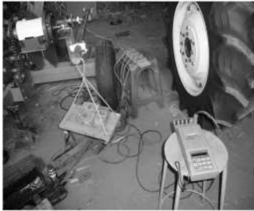
Gambar 2. Pembacaan strain saat diberi beban
