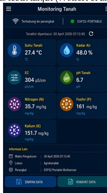
Gambar 4. Antarmuka aplikasi Android untuk monitoring parameter tanah.
