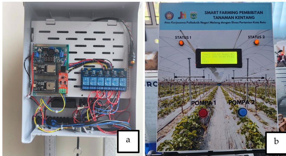
Gambar 3. (a) Box Panel IP65 (b) Implementasi fisik perangkat kontrol
