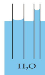
Gambar 3. Fenomena Sistem Kapilaritas pada Fluida Air
